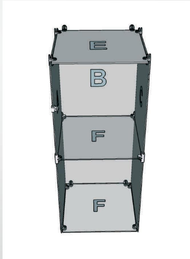
Schieben Sie die Glasplatten (F) und die Alu-Kunststoffplatte (E) in die Verbinder ein und ziehen Sie die Schrauben fest an.
