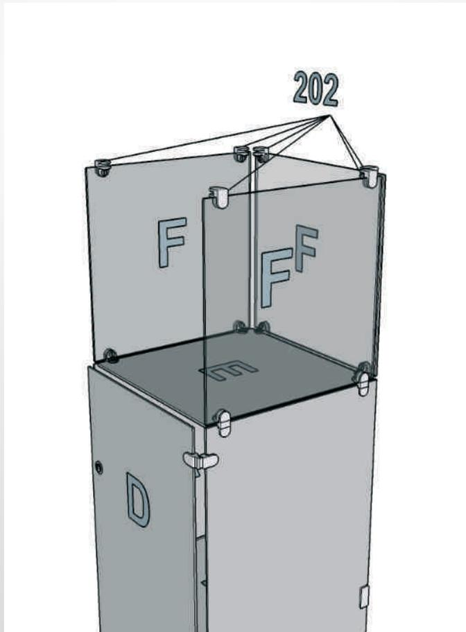
Befestigen Sie die senkrechten Glasplatten (F) in den 3-Wege-Verbindern und montieren Sie die 2-Wege-Verbinder auf den Glasplatten. Die Verbinder sollten ca. 2 cm von den Ecken eingerückt sein.
