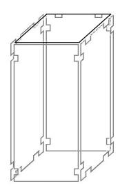
Schieben Sie nun die Deckplatte (D) von vorne in die bereits montierten 3-Wege-Verbinder ein und ziehen Sie die Schrauben fest an.
