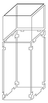
Schieben Sie die Deckplatte (E) von vorne in die montierten 2-Wege-Verbinder und ziehen Sie die Schrauben fest an.
