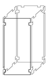
Bringen Sie nun die Platte (C) zwischen den bereits verbunden Platten an und ziehen Sie die Schrauben der Verbinder fest.
