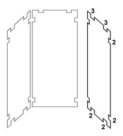
Verbinden Sie die Platte (A) an den bereits montierten Verbindern (2) und schrauben Sie diese fest.
