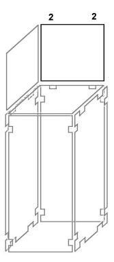
Stellen Sie die Glasplatte in die montierten 3-Wege-Verbinder und ziehen Sie die Schrauben fest an.
