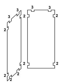
Verbinden Sie die 2 Platten (A) & (B) mit 2 Verbinder (2) an den vorgesehenden Aussparungen.
