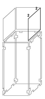
Stellen Sie die Glasplatte in die montierten 3-Wege-Verbinder und ziehen Sie die Schrauben fest an.
