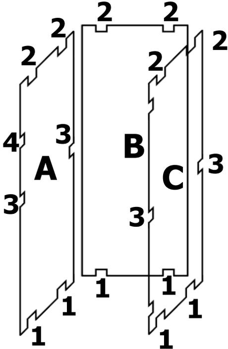
Schieben Sie die Glasplatten und Alu-Kunststoff-Verbundplatte in die Verbinder ein und schrauben Sie diese fest.
