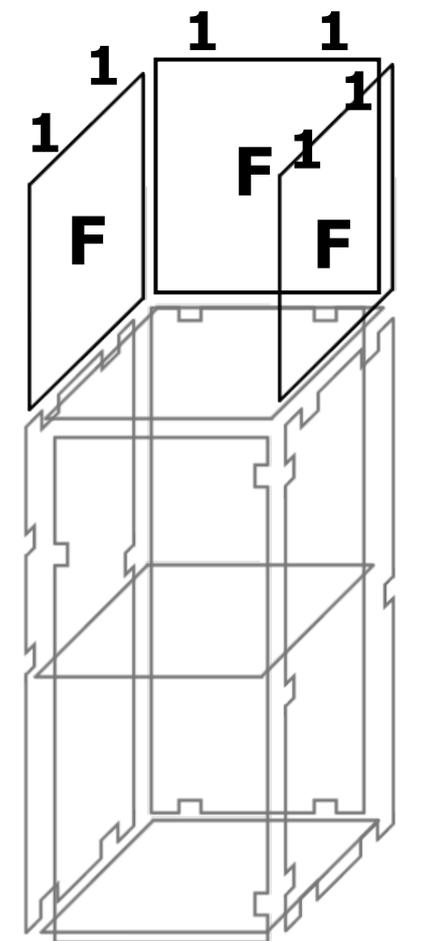
Befestigen Sie die Glasplatten an den Verbindern auf dem Korpus und fixieren Sie die Eckverbinder (1)
