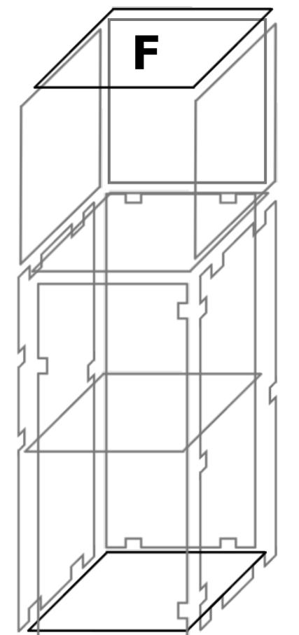
Schieben Sie die Deckplatte (F) ein und befestigen diese mit den Verbindern
