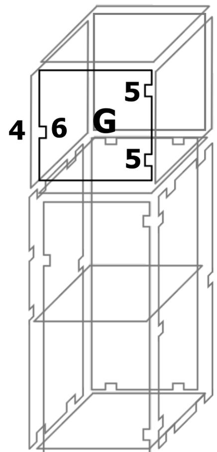
Befestigen Sie die Scharniere und das Schloss an der Glastüre und befestigen Sie diese an dem Glaskubus
