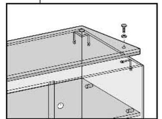
Legen Sie das Oberteil auf und befestigen Sie die hinteren Schrauben A an den 3-Wege Verbindern.
