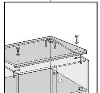
Legen Sie das Oberteil auf und befestigen Sie die hinteren Schrauben A an den 3-Wege Verbindern.
